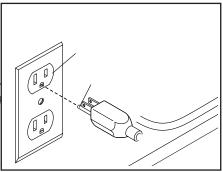
всеми местными нормами и правилами. Розетки должна быть рассчитана на номинальное напряжение 120 вольт. A temporary adapter may be used to connect the power cord to a 2-pole receptacle as shown at the right if a properly grounded outlet is not available.
