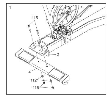
2. Соедините переднюю опору (3) с основанием (2) при помощи двух болтов М10 х 60mm (115), двух шайб М10 (112) и двух га ек М10 (116).
